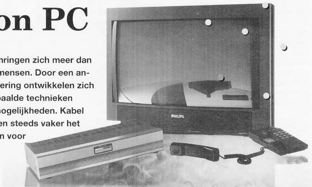
Philips heeft al een 'digital terminal' beschikbaar, bestaande uit een digitale decoder is geschikt voor de nieuwe dienst 'Video-on-Demand'. Via de telefoon wordt een dienst besteld en via de (kabel)decoder verschijnt deze op het scherm van een (breedbeeld) televisie.
